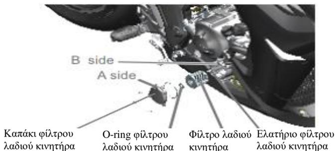
4. Πριν τοποθετήσετε το καπάκι του φίλτρου λαδιού κινητήρα, παρακαλούμε να ελέγξετε τα λαστιχάκια στεγανοποίησης για τυχόν φθορές. Αν υπάρχουν φθορές, παρακαλούμε για την αντικατάστασή τους με καινούργια. Τοποθετήστε το καπάκι του φίλτρου λαδιού κινητήρα και σφίξτε τα παξιμάδια.
