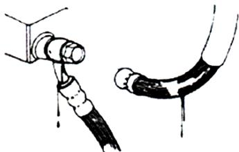
(Χαλάρωση, διαρροή, καταστροφή σωληνώσεων φρένου)
